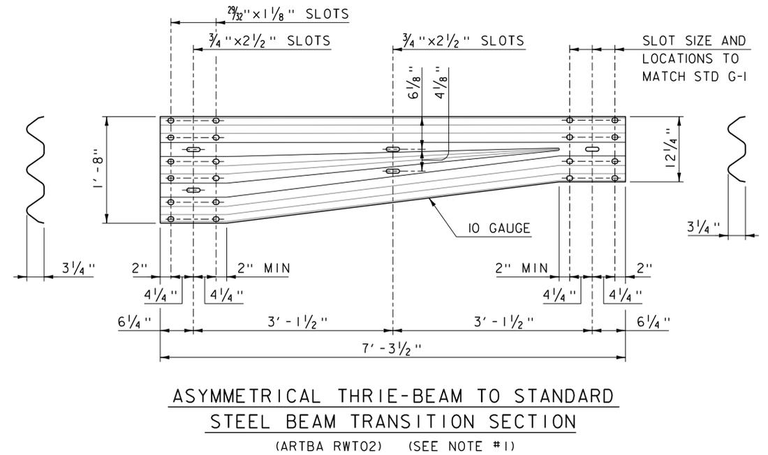
**ASYMMETRICAL THRIE-BEAM TO STANDARD STEEL BEAM TRANSITION SECTION**
