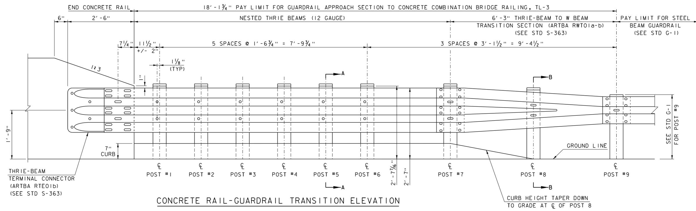
CONCRETE RAIL-GUARDRAIL TRANSITION ELEVATION
