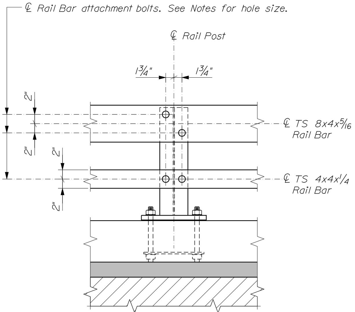
~ TYPICAL RAILING ELEVATION ~
