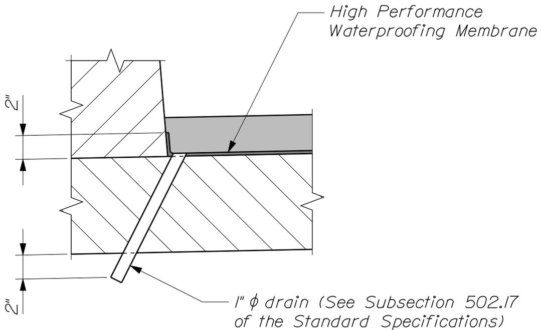
~ GUTTER DETAIL FOR BITUMINOUS W. S. ~
