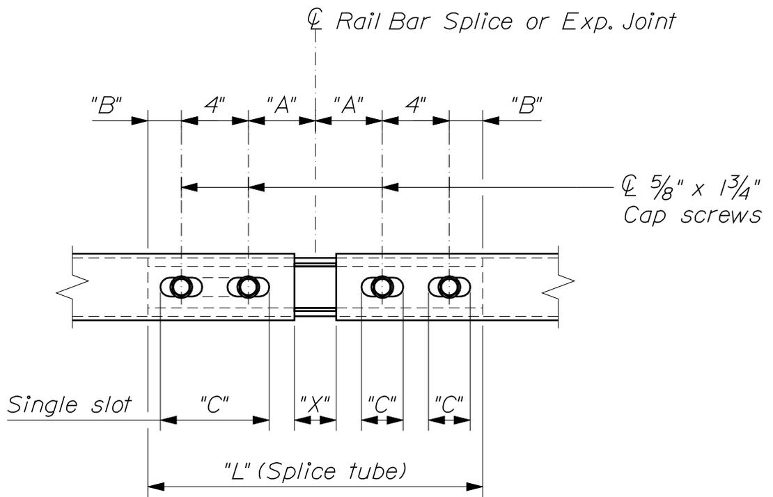
~ RAIL BAR SPLICE & EXPANSION JOINT DETAIL ~
