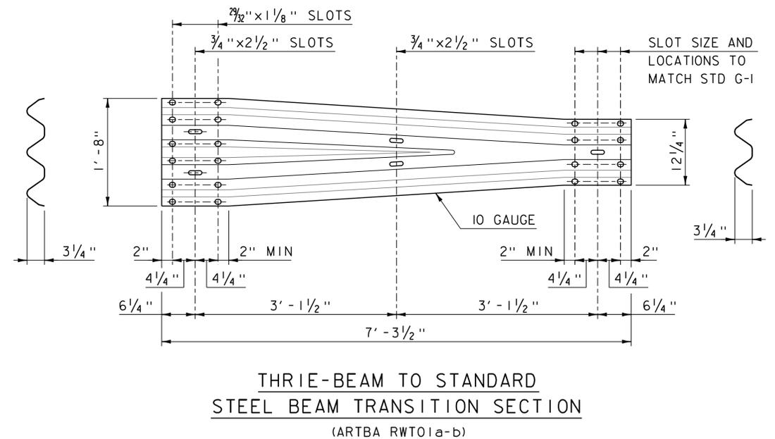
**THRIE-BEAM TO STANDARD STEEL BEAM TRANSITION SECTION**
