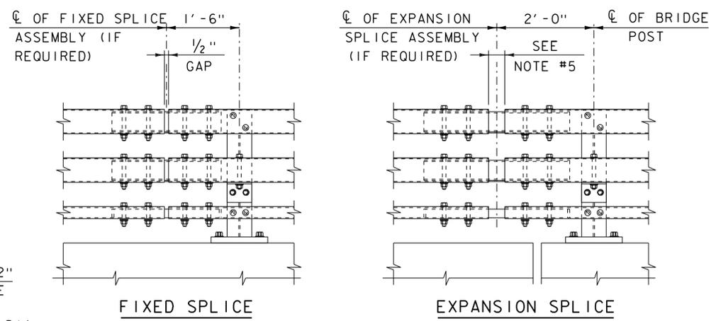
RAILING SPLICE DETAIL ELEVATION
