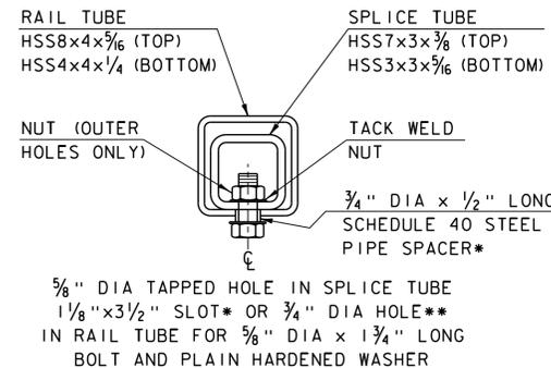
A-A RAIL TUBE SPLICE AND RAIL EXPANSION JOINT SECTION
