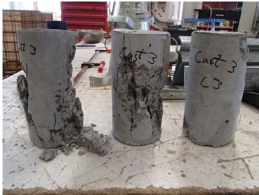
(e) Closure pour concrete cylinder tests
