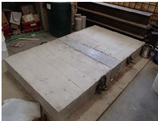
(e) Closure pour after casting
